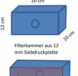
Filterkammer Innenseite mit Haltegitter für Filter
